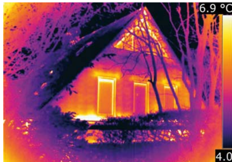
Auch bei diesem Einfamilienhaus geht die meiste Energie über die Gebäudehülle verloren – Zeit für energetische Maßnahmen!
